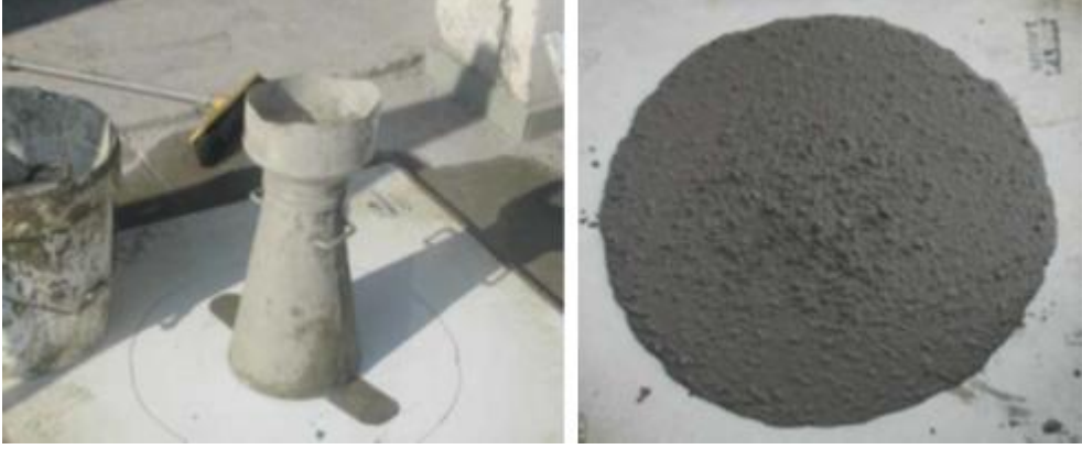
Resim 6.1: Yayılma deneyinde kullanılan huni ve 50 cm'lik çap işaretli tabla, nihai yayılma çapı
